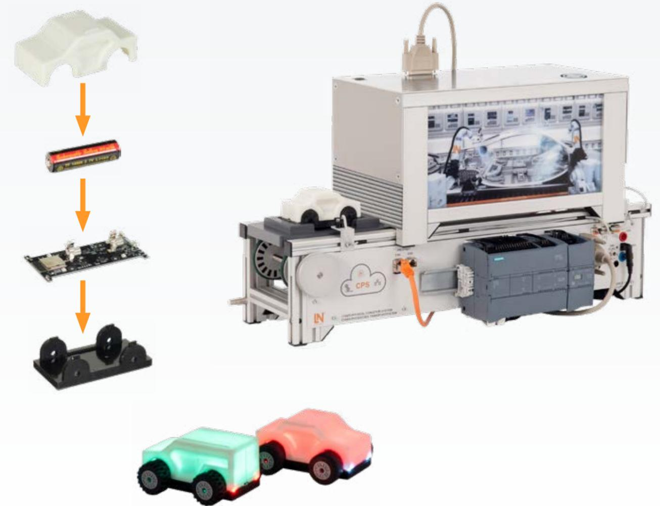
Ob 3D-Druck oder Produktion: Das Herzstück ist das ERP-Lab. Das ERP-Lab vernetzt alle Module Ihres Labors miteinander. Durch die Nutzung von OPC-UA können weitere Geräte, wie Sensoren und Roboter eingebunden und angesprochen werden.
