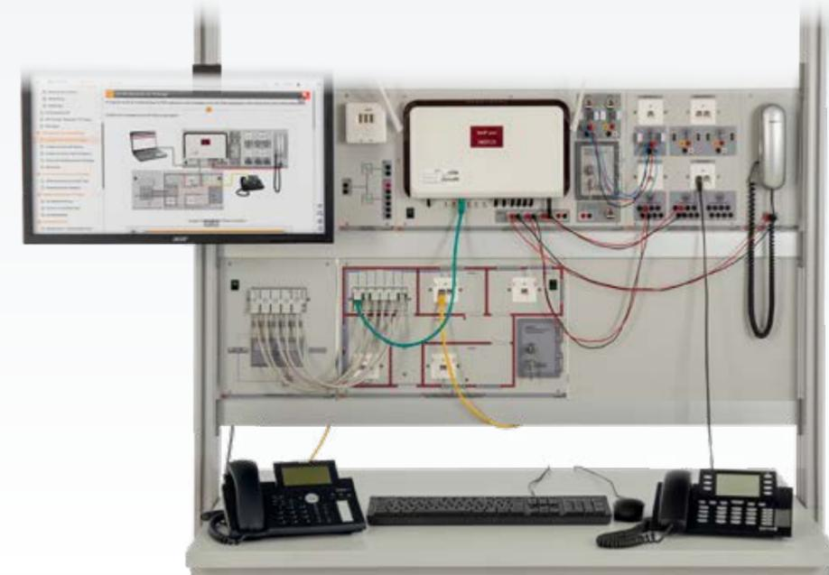
Das Trainingssystem ermöglicht Aufbau, Inbetriebnahme, Konfiguration und Fehlersuche an einer typischen Büro-TK-Infrastruktur. Die Ausstattung kann entweder autark genutzt oder in ein bestehendes Telefonsystem oder lokales Netzwerk integriert werden.
