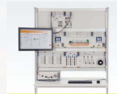
EUL 5 – Untersuchung an Drehstromkabeln
