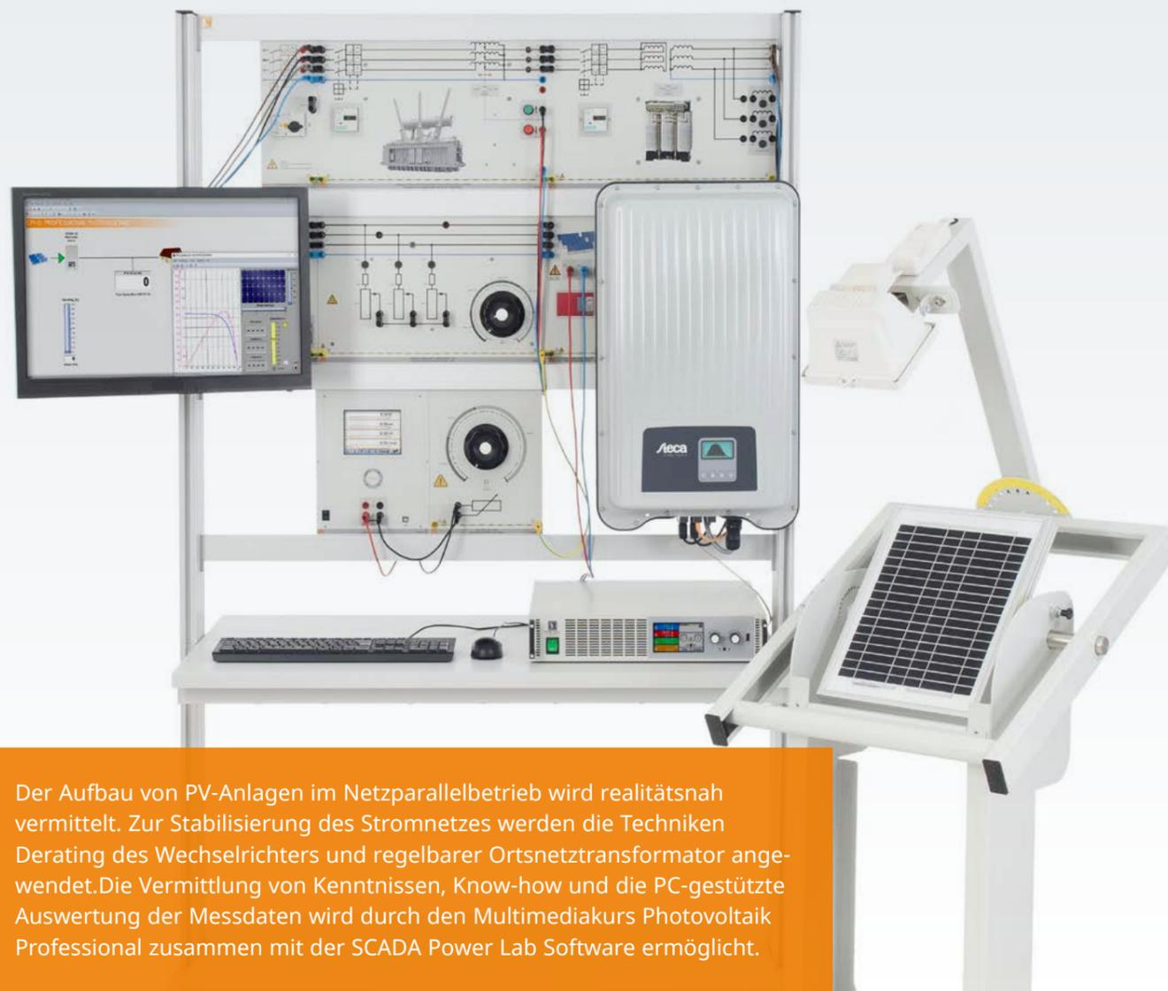
Der Aufbau von PV-Anlagen im Netzparallelbetrieb wird realitätsnah vermittelt. Zur Stabilisierung des Stromnetzes werden die Techniken Derating des Wechselrichters und regelbarer Ortsnetztransformator angewendet. Die Vermittlung von Kenntnissen, Know-how und die PC-gestützte Auswertung der Messdaten wird durch den Multimediakurs Photovoltaik Professional zusammen mit der SCADA Power Lab Software ermöglicht.
