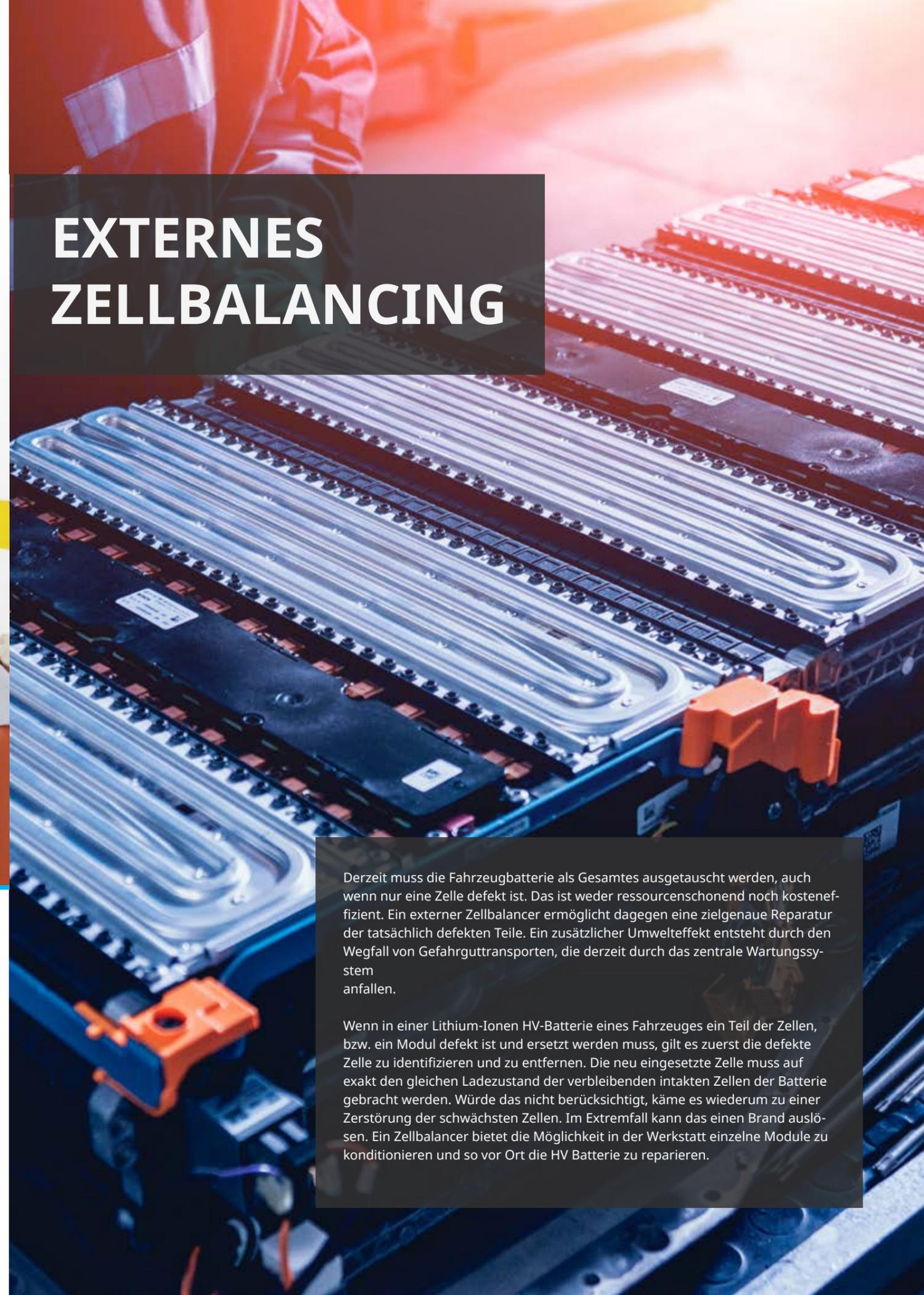
Derzeit muss die Fahrzeugbatterie als Gesamtes ausgetauscht werden, auch wenn nur eine Zelle defekt ist. Das ist weder ressourcenschonend noch kosteneffizient. Ein externer Zellbalancer ermöglicht dagegen eine zielgenaue Reparatur der tatsächlich defekten Teile. Ein zusätzlicher Umwelteffekt entsteht durch den Wegfall von Gefahrguttransporten, die derzeit durch das zentrale Wartungssystem anfallen.
