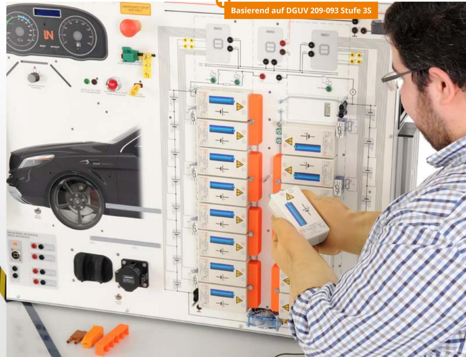
Direktes Arbeiten an und in einer realen HV-Batterie: Der Aufbau entspricht exakt dem einer HV-Batterie im Serienfahrzeug. Mit dem Trainingssystem können Auszubildende in der Hochvoltbatterie messen und diagnostizieren, auf Zellebene arbeiten und einzelne Zellen wechseln.
