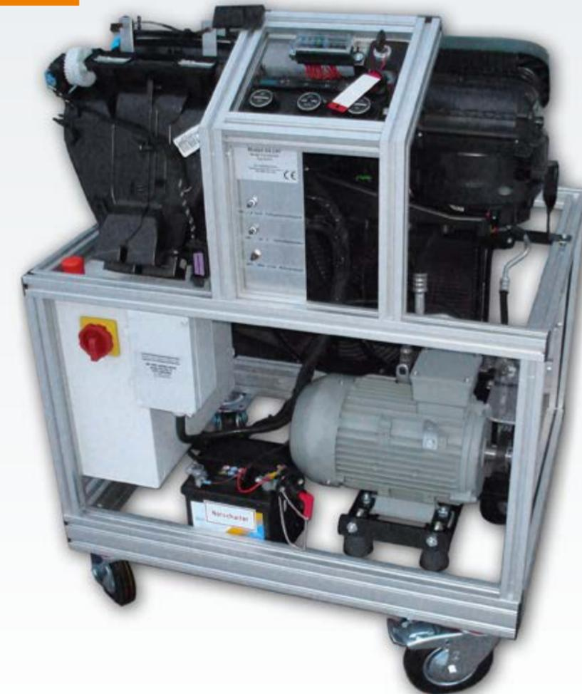
Ein Schulungsmodell, das alle notwendigen Diagnosekompetenzen an einer realen 2-Zonen-Klimaanlage vermittelt. Es besteht zu 100 Prozent aus OEM-Komponenten eines VW Golf 5 und ermöglicht so eine authentische Lernerfahrung. Selbst der Anschluss einer Klimaservicestation an den vollständigen Kältemittelkreislauf mit Expansionsventil ist kein Problem.
