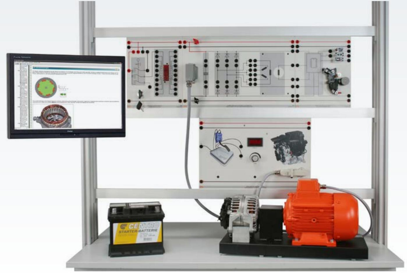
In heutigen Kompaktgeneratoren kommt der Monolithregler zum Einsatz. Dieser sogenannte Multifunktionsregler (MFR) hat den Hybridregler weitgehend ersetzt. Das Trainingssystem unterrichtet die Energieerzeugung in modernen Kraftfahrzeugen mittels aufeinander aufbauender Experimente.
