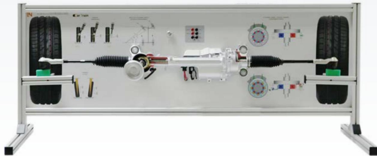
Elektromechanische Servolenkungen bieten viele Vorteile gegenüber Lenkungen ohne Lenkhilfe. Sie unterstützen den Fahrer nicht nur physisch, sondern auch psychisch. Die Lenkunterstützung erfolgt bedarfsorientiert. Das heißt, sie wird nur dann aktiv, wenn sie vom Fahrer gewünscht ist. Gleichzeitig ist sie von Geschwindigkeit, Lenkmoment und -winkel abhängig.
