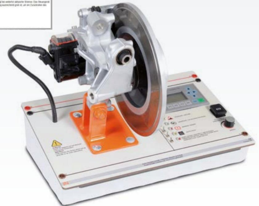
Die elektromechanische Feststellbremse ersetzt die herkömmliche Handbremse durch einen Schalter in der Armaturentafel. Der Handbremshebel entfällt. Über den Schalter kann die Feststellbremse mittels eines elektronischen Aktors an den hinteren Reifen aktiviert werden.
