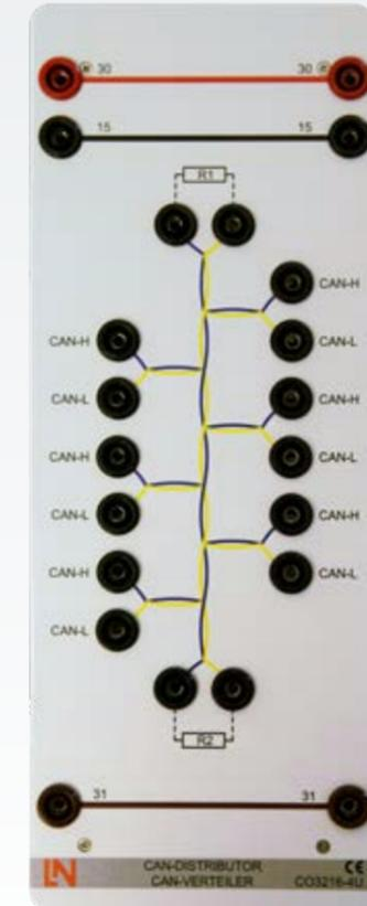
Eine Vertiefung des Themas CAN-Bus: Der Auszubildende wird durch diesen Kurs bei dem Aufbau eines eigenen CAN-Netzwerks unterstützt. Durch den CAN-Verteiler kann in kurzer Zeit ein komplexes Netzwerk in Betrieb genommen werden.
