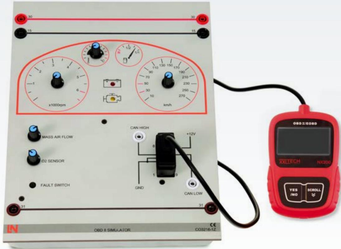
Abgasrelevante Bauteile mithilfe der On-Board-Diagnose (OBD II oder EOBD) auslesen: Dieses System vermittelt, wie der OBD-Tester korrekt eingesetzt und dessen Funktionsumfang optimal ausgenutzt wird. Auch die korrekte Interpretation der ausgelesenen Fehler steht im Fokus des Kurses.
