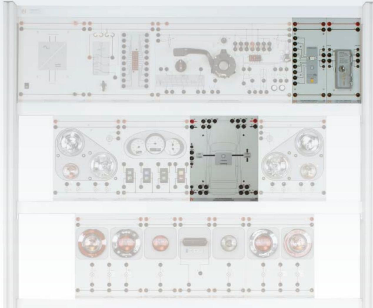
Erweitern Sie jede Beleuchtungswand um ein voll diagnosefähiges CAN-Bus-Netzwerk. Neben dem Betrieb im Low-Speed-Modus ermöglicht dieses neue Konzept auch den High-Speed-Modus – einfach per Knopfdruck. So veranschaulichen Sie die Grundlagen verschiedener Übertragungsgeschwindigkeiten und die damit verbundenen Spannungspegel.
