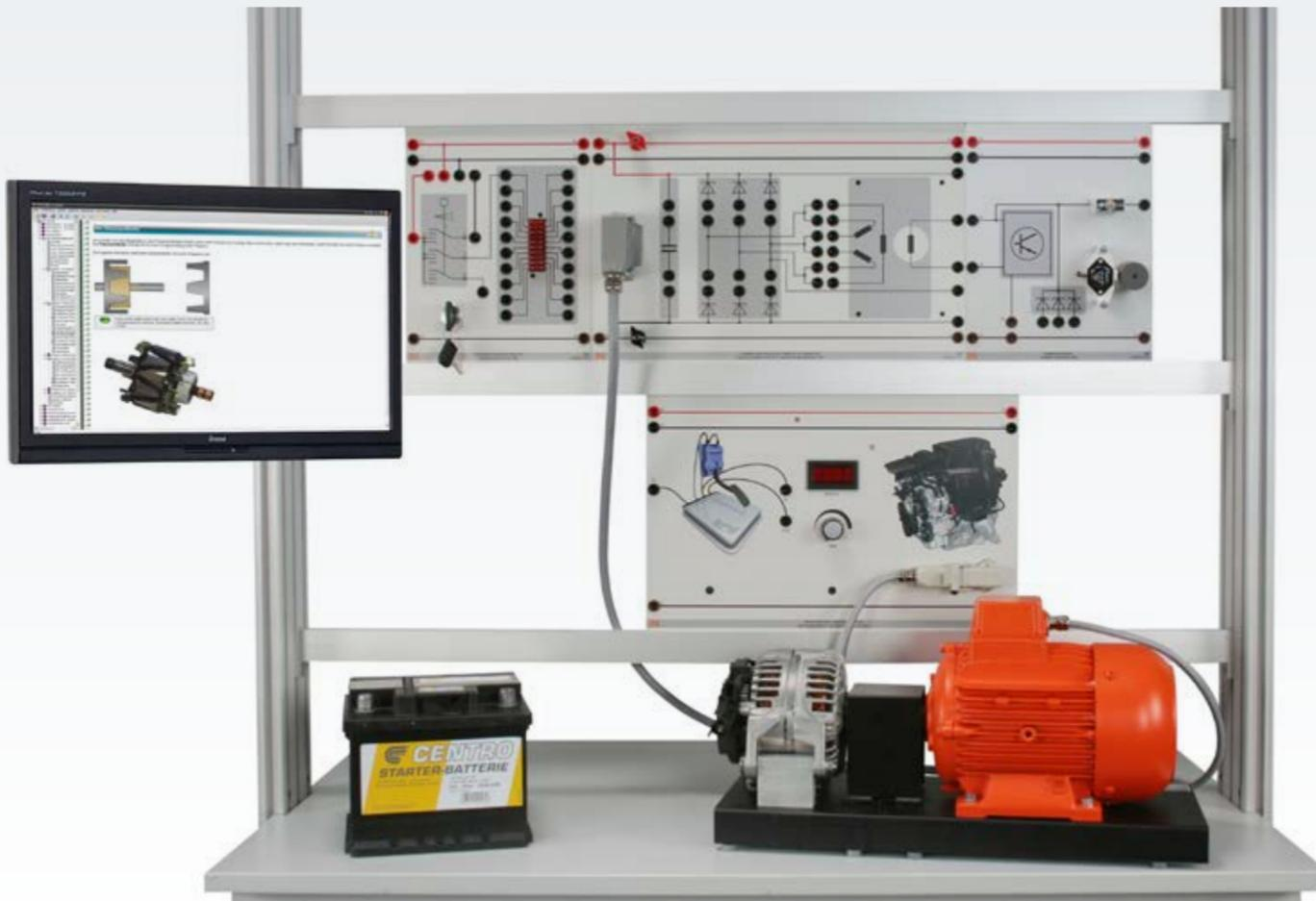
Mit unserem Trainingssystem lernen die Auszubildenden die Aufgabe des Hybridreglers kennen. Sie experimentieren selbst und beobachten, wie man die Generatorspannung bei allen Drehzahlen und Belastungen auf einem bestimmten Niveau hält. Weitere Themen sind die Rolle des mittleren Erregerstroms, die Veränderungen des magnetischen Feldes und der Induktion in der Ständerwicklung.
