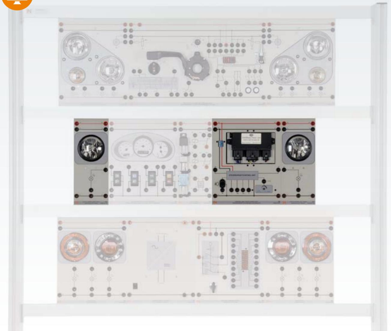
Das statische Kurvenlicht erweitert das Beleuchtungssystem des Kraftfahrzeugs um ein Steuergerät und zwei Zusatzscheinwerfer. Für das Fahren bei Dunkelheit bedeutet dies einen Zuwachs an Komfort und Sicherheit. Dafür besitzt das System einen Neigungssensor im spezifischen Steuergerät. Neben dieser entscheidenden Komponente erläutert unsere Erweiterung auch die genaue Funktionsweise des Gesamtsystems.
