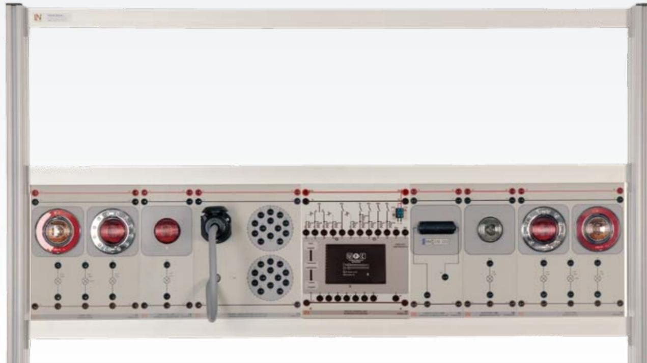
Auch für die Vermittlung des Themas Anhängerbeleuchtung gilt: Die Ansprüche sind mit der Komplexität der elektrischen Anlage deutlich gestiegen. Der Lerninhalt dieses Systems geht daher über das Prinzip der 7- bzw. 13-poligen Belegung der Steckverbindung hinaus. Gleichzeitig erklärt es, wie das Zugfahrzeug vor Überlastung geschützt wird und wann die Kontrollfunktionen am Anhänger den Vorschriften entsprechen.
