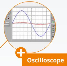
Le logiciel SCADA (Supervisory Control and Data Acquisition) est utilisé pour visualiser les flux d'énergie complexes à l'intérieur de l'onduleur hybride compact et pour afficher les états du système. L'oscilloscope intégré permet d'analyser le fonctionnement et la qualité de la tension modulée de l'onduleur. La courbe dans le temps des valeurs mesurées peut être enregistrée à l'aide du logger ou enregistreur.
