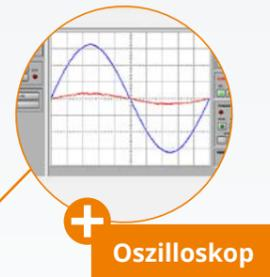
Mit Hilfe von Supervisory Control and Data Acquisition (SCADA) werden die komplexen Energieflüsse innerhalb des kompakten Hybrid-Wechselrichters visualisiert und Systemzustände dargestellt. Das integrierte Oszilloskop ermöglicht die Analyse des Wechselrichters auf Funktionsweise und Qualität der modulierten Spannung. Der zeitliche Verlauf von Messwerten können mit dem Logger aufgezeichnet werden.
