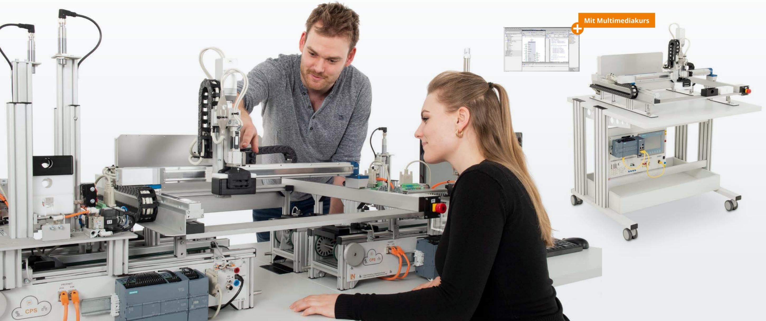
Der Portalroboter kann nicht nur als Einzelsystem zur Vermittlung von Grundlagen verwendet werden. Das Portal ist so konzipiert, dass es viele Einsatzmöglichkeiten bietet. Mit einer beliebigen Steuerung lassen sich unterschiedlichste Projektbeispiele programmieren. Positioniert auf dem passenden Portal-Tisch können die im Kurs beschriebenen Auflagemasken passgenau in die dafür vorgesehenen Halterungen gesteckt werden.
