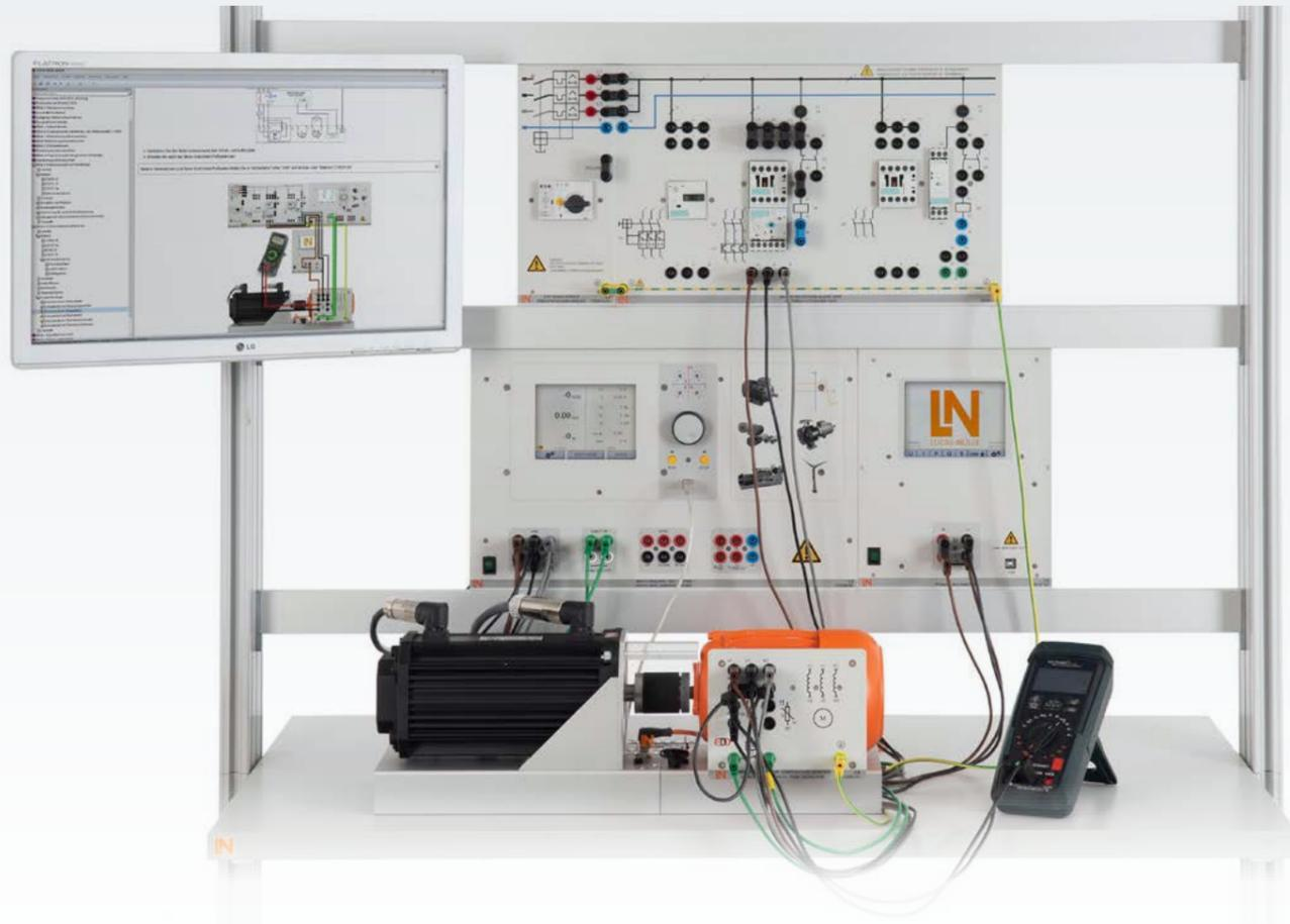
Les moteurs à cage d'écureuil sont conçus pour un état de charge constant. Les modifications de l'état de charge, tout comme les courants de démarrage élevés, entraînent un échauffement du moteur inadmissible. Des capteurs surveillent la température et le courant absorbé du moteur. Ils actionnent des dispositifs de protection tels que disjoncteur de protection réglable, relais de protection du moteur ou relais à thermistance.
