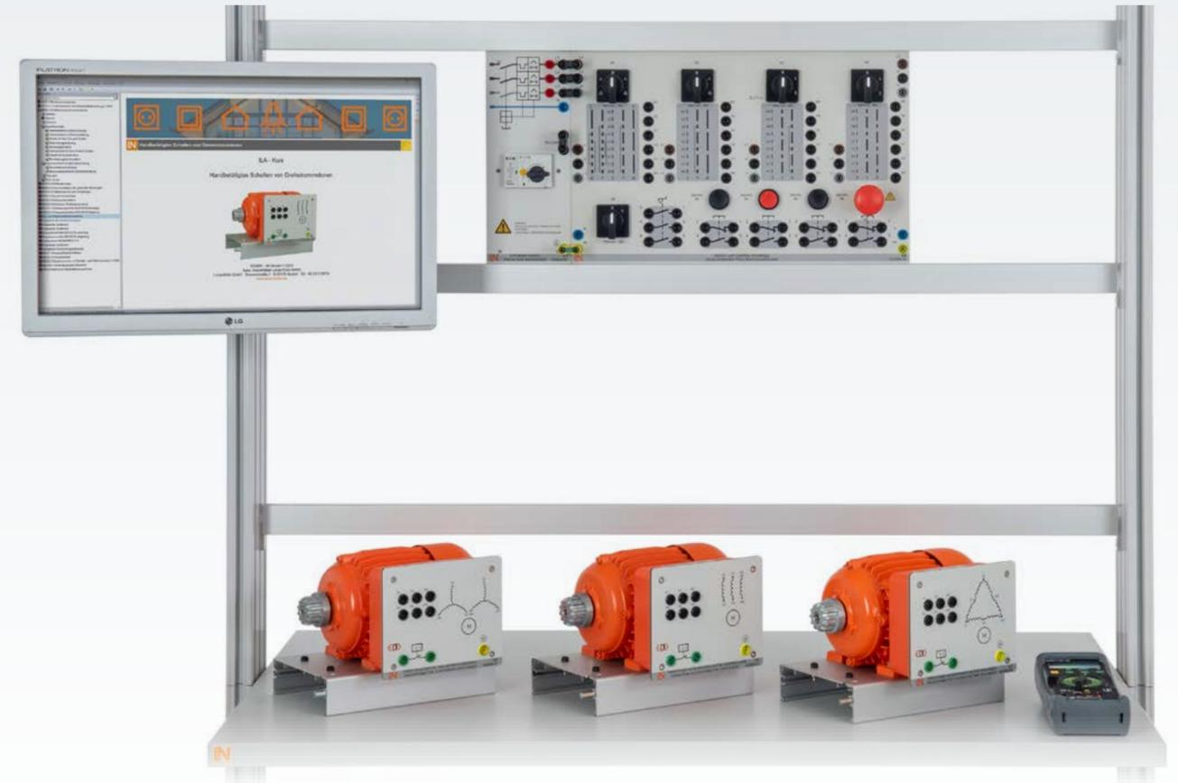
Cette section de la formation se concentre sur la conception de circuits ainsi que sur le choix d'éléments de commutation et d'appareils appropriés. Des moteurs multipolaires peuvent être branchés directement dans un circuit triphasé jusqu'à une certaine classe de puissance. Il existe pour cela des appareils de commutation adaptés à chaque application.
