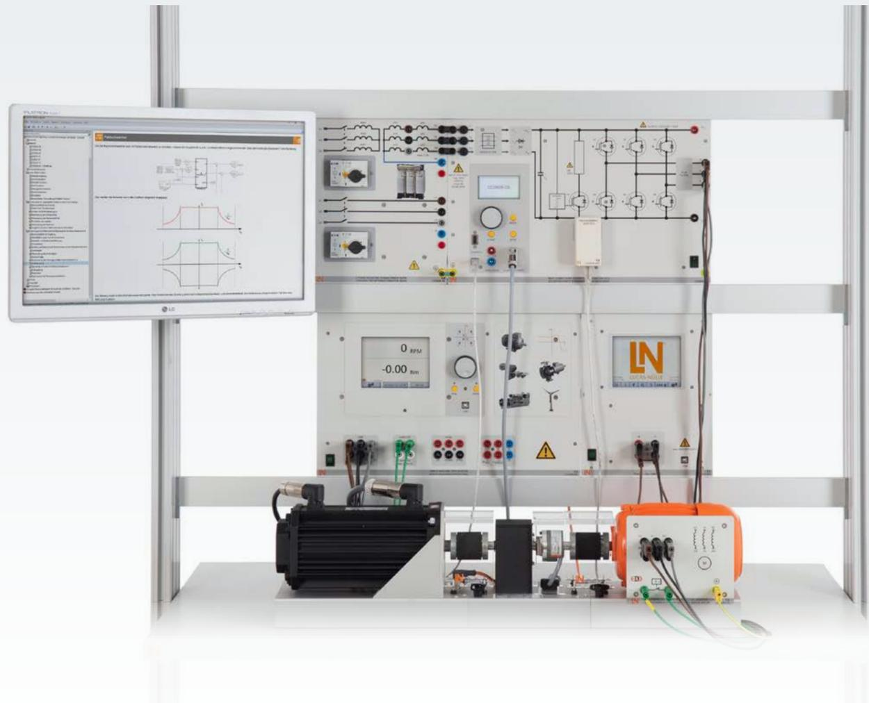
Aujourd'hui, les entraînements triphasés sont utilisés dans presque tous les moteurs électriques. La régulation de ces entraînements est fastidieuse et complexe d'un point de vue mathématique. Ce système d'apprentissage permet, à l'aide d'une boîte à outils spéciale pour Matlab®/ Simulink®, de simuler des algorithmes de régulation complexes puis de les tester sur un matériel réel à sécurité intrinsèque avec moteur et charge à l'aide d'un code généré automatiquement.
