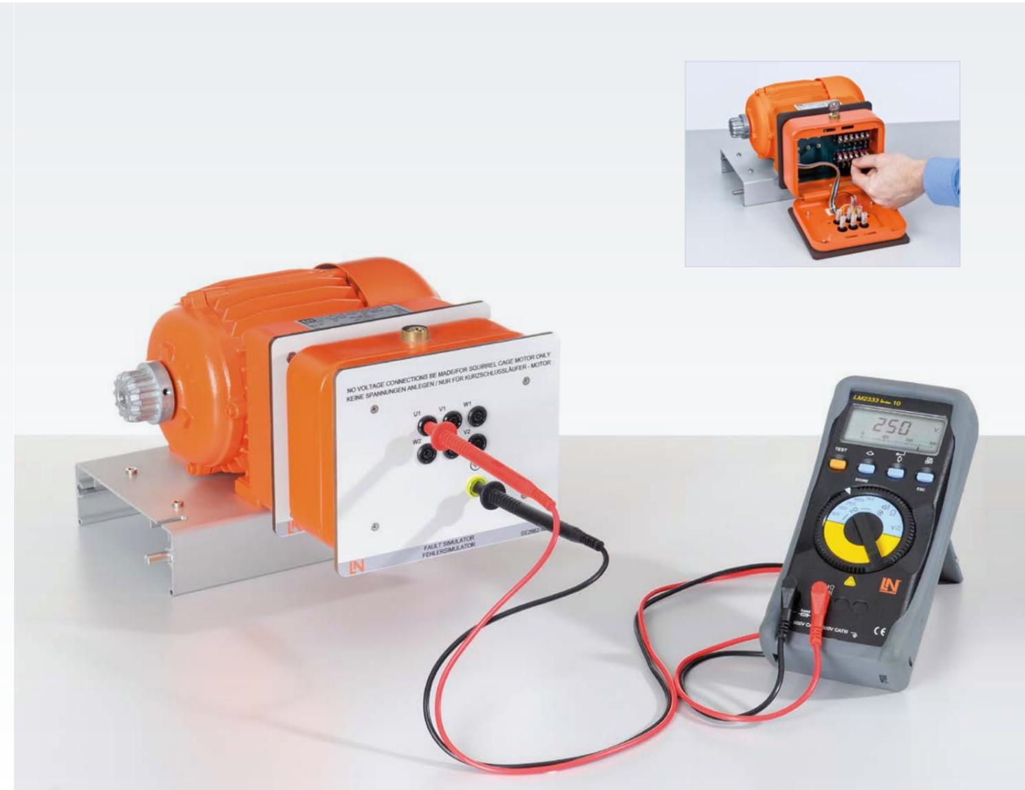
Le simulateur d'erreur s'enfiche tout simplement sur le moteur asynchrone à courant triphasé. Des interrupteurs d'erreur verrouillables permettent d'activer différentes erreurs qui peuvent survenir en pratique. Ces erreurs peuvent être détectées et analysées au moyen d'instruments de mesure typiques de l'industrie. Les résultats des mesures permettent alors d'élaborer des approches de réparation. Toutes les mesures sont réalisées à l'état hors tension.
