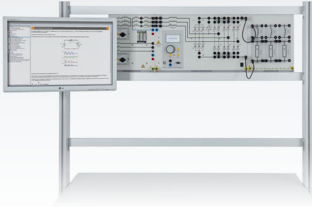
Netzgeführte Stromrichter ermöglichen, Energie aus einem Wechsel- oder Drehstromnetz in einen Gleichstromkreis zu überführen. Sie lassen sich steuerbar mit Thyristoren und Triacs oder nicht steuerbar mit Dioden ausführen.
