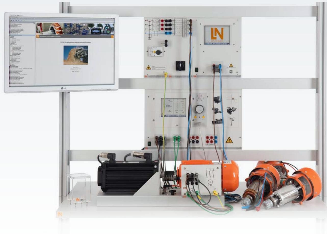
Dieses Lehrsystem besteht aus einem einheitlichen Stator für alle Maschinentypen und einen Satz auswechselbarer Rotoren. Durch den zerlegbaren Aufbau eignet sich der Satz besonders zur Grundlagenvermittlung, da der konstruktive Aufbau und die Unterschiede zwischen den verschiedenen Maschinen untersucht werden können. Im Unterschied zu herkömmlichen Schnittmodellen sind die Maschinen voll funktionsfähig und lassen sich mit dem Maschinenprüfsystem koppeln.
