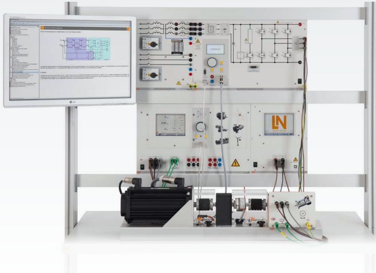
Servoantriebe sind geregelte Antriebe mit hoher Anforderung an Dynamik und Überlast. Sie werden oft in Automatisierungslösungen mit starken Drehzahl- und Drehmomentenänderungen eingesetzt, wie z. B. in Werkzeugmaschinen oder Robotersystemen. Das Trainingssystem „Servoantriebe“ zeigt in anschaulicher Weise die Funktion eines geregelten Servosystems mit Permanentmagnet.
