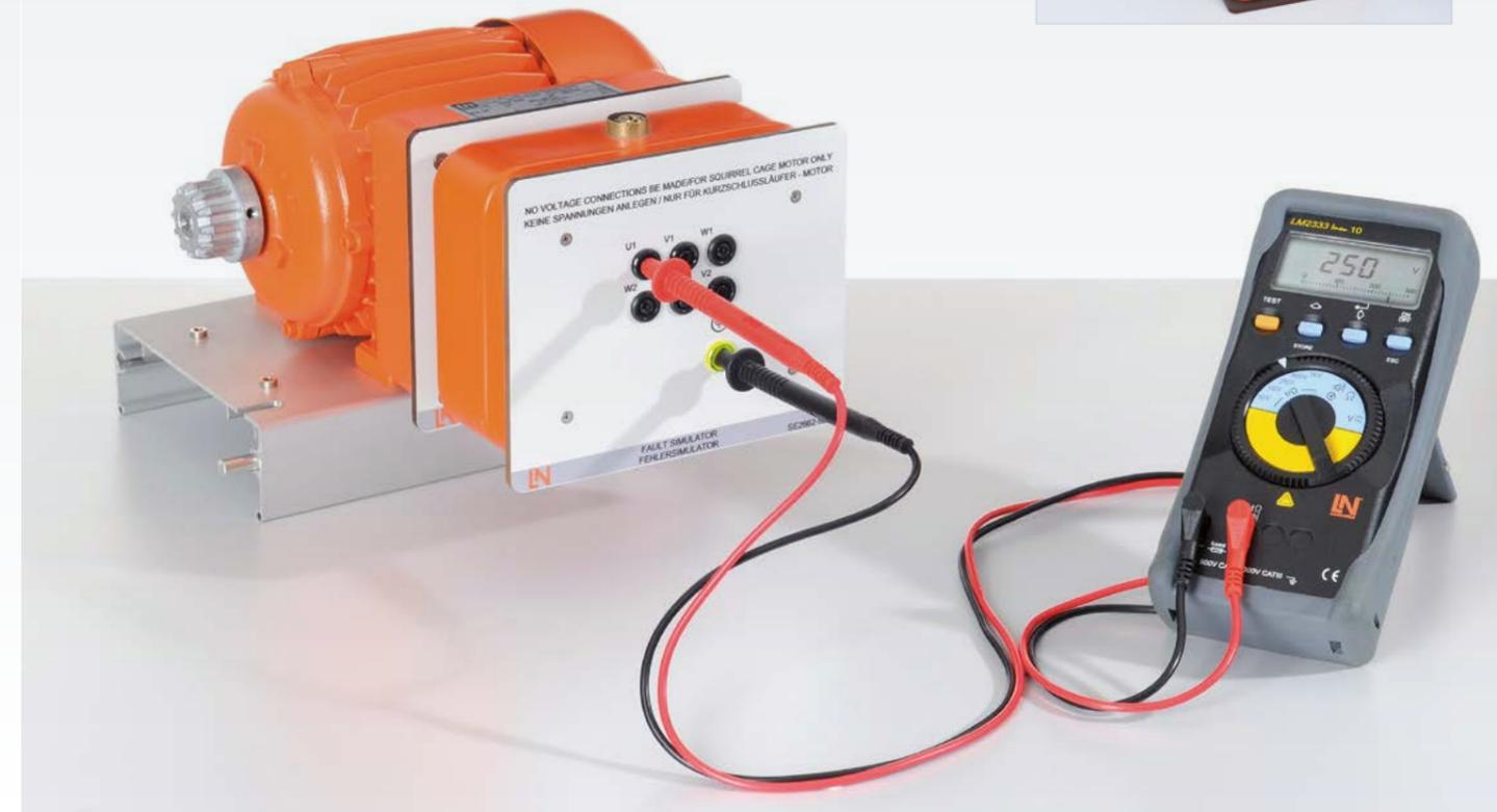
Der Fehlersimulator lässt sich einfach auf einem Drehstrom-Asynchronmotor aufstecken. Durch abschließbare Fehlerschalter lassen sich verschiedenste praxisrelevante Fehler aktivieren. Diese können mit industrietypischen Messgeräten gefunden und analysiert werden. Aus den Messergebnissen lassen sich Reparaturansätze erarbeiten. Alle Messungen werden im stromlosen Zustand vorgenommen.
