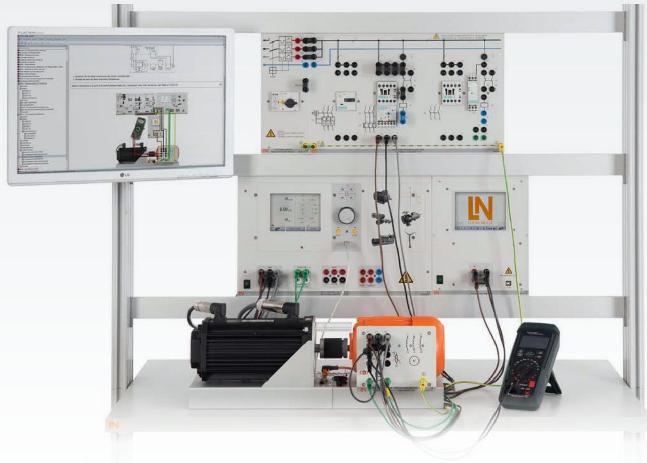
Käfigläufermotoren sind für einen gleichbleibenden Lastzustand konzipiert. Änderungen des Lastzustandes, aber auch hohe Anlaufströme führen zu unzulässiger Erwärmung des Motors. Sensoren überwachen die Temperatur und die Stromaufnahme des Motors. Sie aktivieren Schutzvorrichtungen wie Motorschutzschalter, Motorschutzrelais oder Thermistorrelais.
