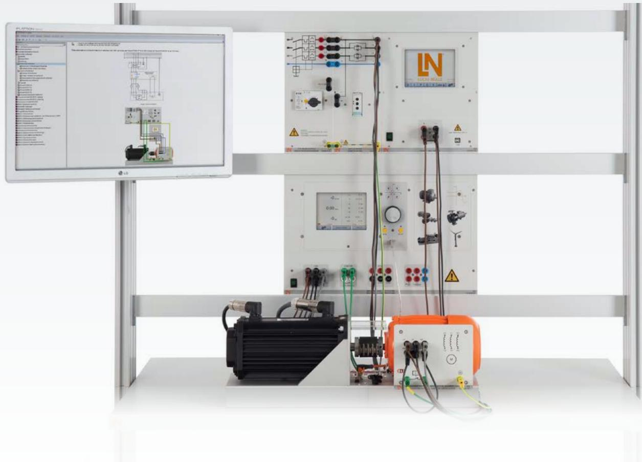
Sanftstarter reduzieren beim Einschalten durch Phasenanschnitt die Spannung des Motors. Proportional zur Klemmenspannung sinkt der Anlaufstrom. Das Leistungsteil eines Sanftstarters besteht meist aus zwei antiparallel geschalteten Thyristoren je Phase. Um die Verluste und die damit entstehende Wärme so klein wie möglich zu halten, werden die Leistungshalbleiter nach der Anlaufphase durch ein integriertes Leistungsschütz überbrückt.
