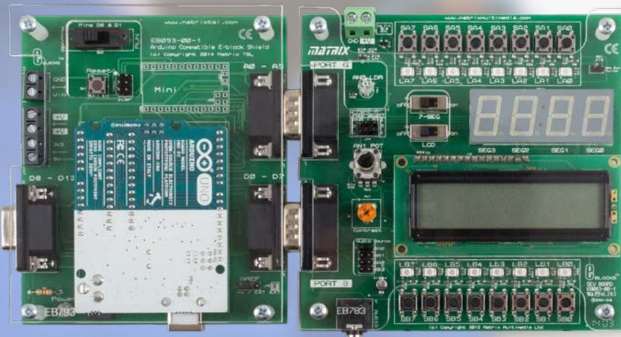
Arduino est une plateforme de prototypage rapide (Rapid Prototyping). Le matériel se compose d'une unité d'expérimentation Programmeur avec un microcontrôleur ATmega328 et une unité d'expérimentation des applications avec un écran, des LED (DEL), des boutons poussoirs, des interrupteurs, des capteurs, etc.
