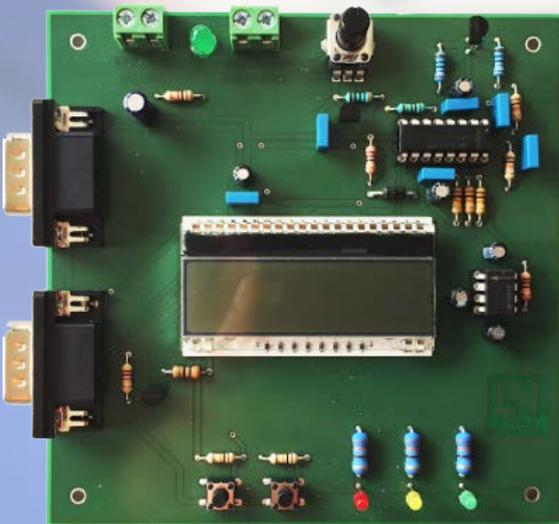
Cet équipement comprend un thermomètre de qualité supérieure commandé par microcontrôle et doté d'un affichage LCD.
