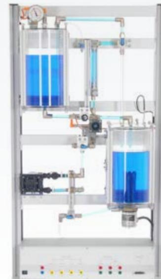
Régulation d'une installation du domaine de la technique des procédés avec le régulateur numérique
