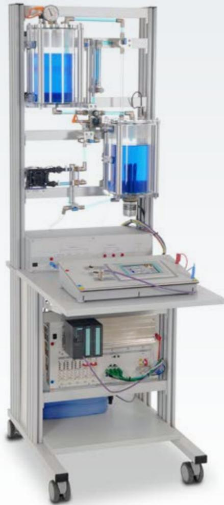
IPA 1 Boucle de régulation avec Automate Programmable Industriel (API)
