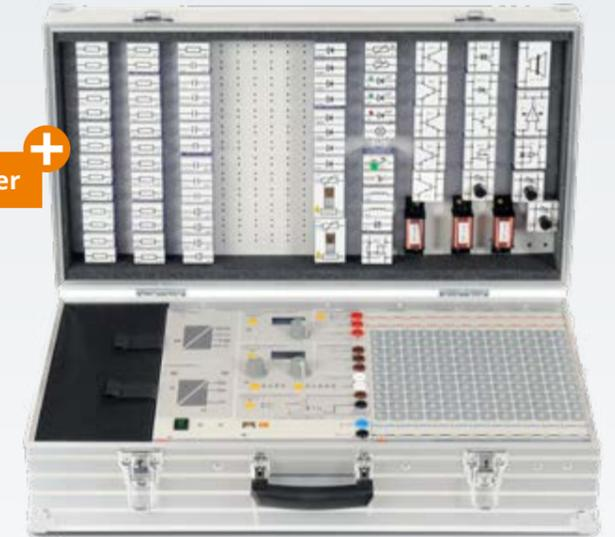
Mit dem Satz, bestehend aus 82 Stück 4-mm-Steckbausteinen, kann eine Vielzahl an Experimenten aus den Bereichen Elektrotechnik und Elektronik aufgebaut werden. Neben den Experimenten, die in den Handbüchern „Gleichstromtechnik“, „Wechsel- und Drehstromtechnik“, „Halbleiterbauelemente“ und „Grundsaltungen der Elektronik“ behandelt werden, können auch unzählige weitere Schaltungen realisiert werden. Der Satz wird auf einer DIN-A3-Aufbewahrungsplatte mit kratzfestem, farbigem Druck geliefert.
