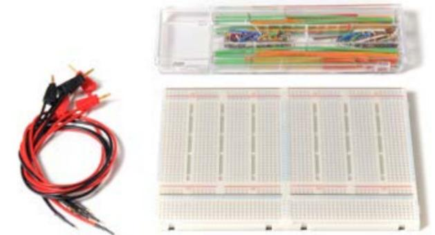
Breadboard zum Schaltungsaufbau mit bedrahteten Bauelementen.
