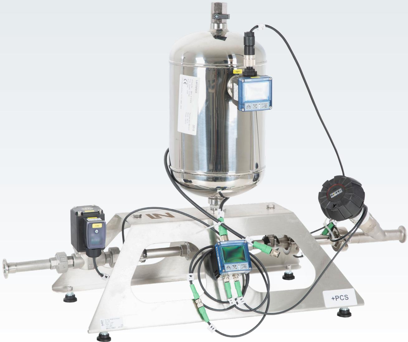
Dans l'industrie des procédés, la régulation de la pression constitue l'une des variables de régulation les plus exigeantes. Le système d'apprentissage de régulation des procédés (PCT) Pression de Lucas Nülle fournit les bases pour une compréhension approfondie de cette régulation.
