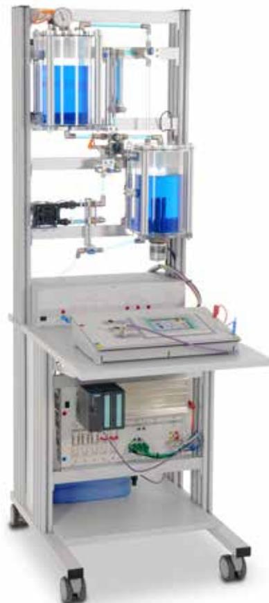
*Boucle de régulation avec Automate Programmable Industriel (API)*
