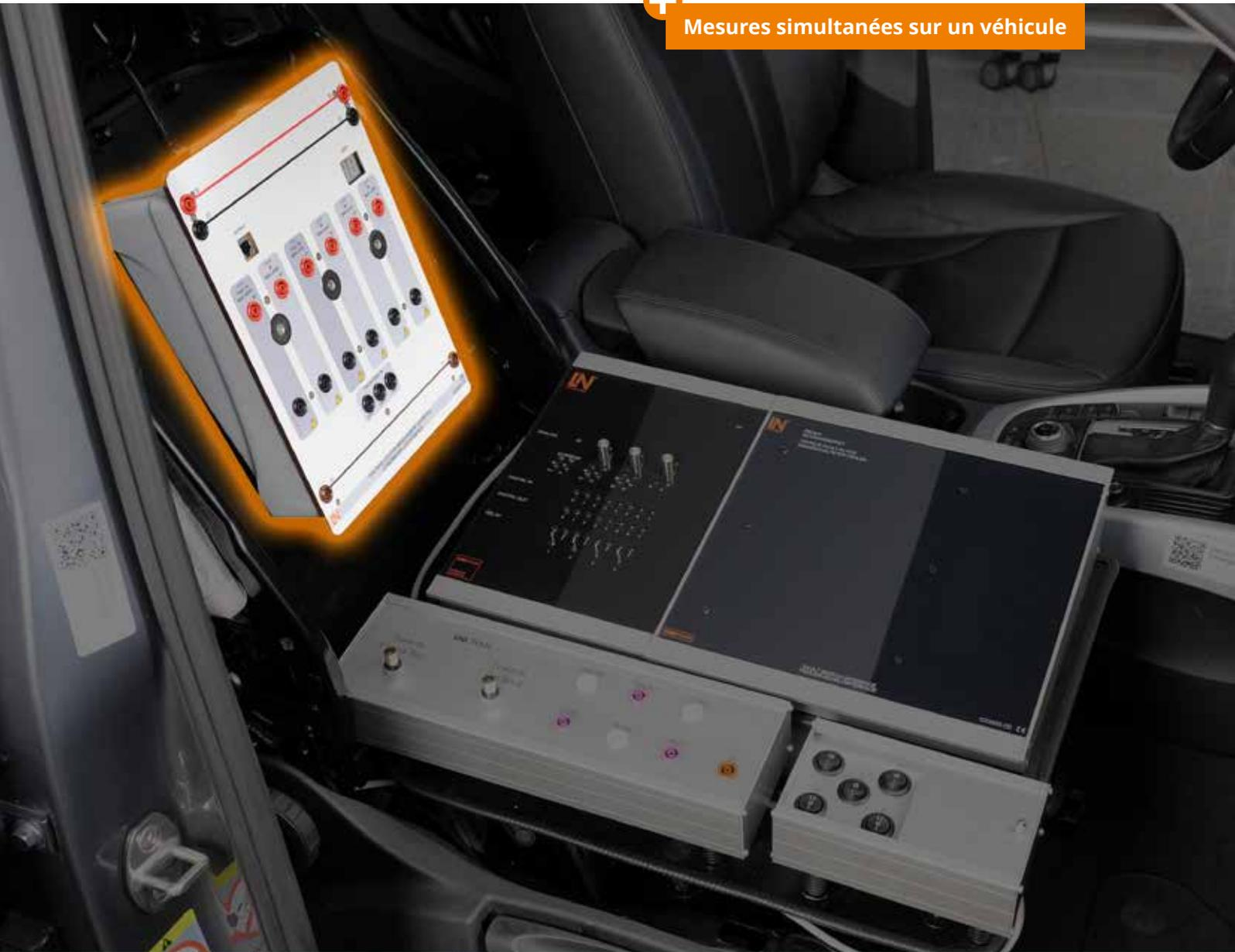
Le pack d'extension permet à plusieurs apprenants d'effectuer en même temps des mesures ou des diagnostics sur un même véhicule en ajoutant des postes de mesure qui leurs sont dédiés.
