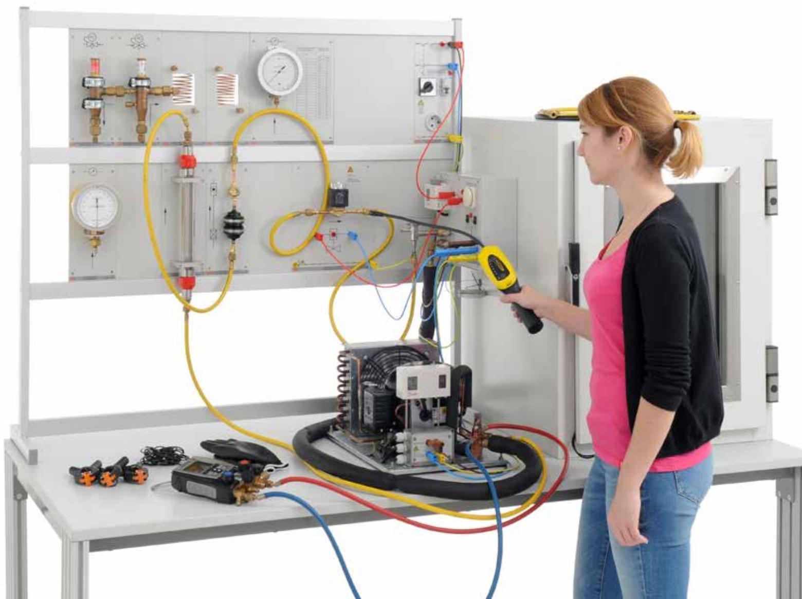
Enseigner la complexité d'une simple installation de froid de façon claire : des animations bien conçues et des instructions détaillées illustrent le fonctionnement d'un circuit réel avec le frigorigène du futur **R290** (propane) – un frigorigène naturel possédant un faible potentiel de réchauffement global (PRG).
