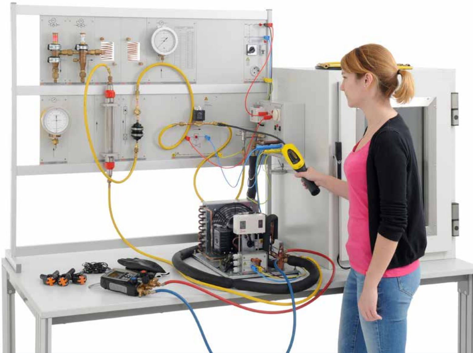
Die Komplexität einer einfachen Kälteanlage anschaulich vermitteln: Gekonnte Animationen und detaillierte Anleitungen zeigen den Betrieb eines realen Kreislaufs mit dem zukunftsweisenden Kältemittel **R290** (Propan) – ein natürliches Kältemittel mit geringem GWP. Der große Vorteil: Im Gegensatz zu vielen anderen Kältemitteln ist es nicht vom „Phase Down“ betroffen.
